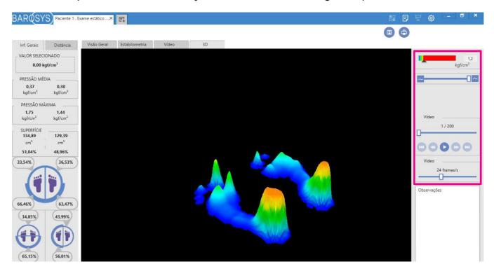
A barra lateral direita contém os controles de exibição de barra de cor, altura do gráfico de pressão, grade e um player de vídeo, em que é possível reproduzir e navegar entre os frames captados.
