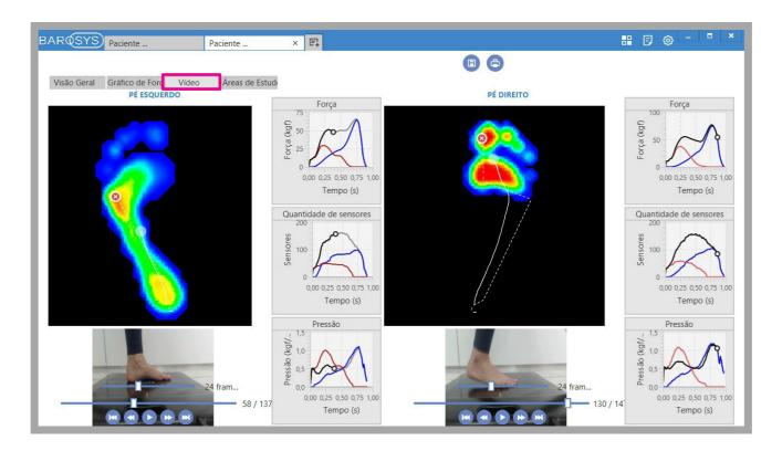
O software BaroSys possibilita a gravação de um vídeo auxiliar durante o exame dinâmico, o Exame Dinâmico com Vídeo. Isto só é possível caso haja uma câmera em seu computador (conectada ou embutida), então as imagens serão sincronizadas com as dos sensores e serão exibidas na aba "Vídeo" do exame dinâmico.
